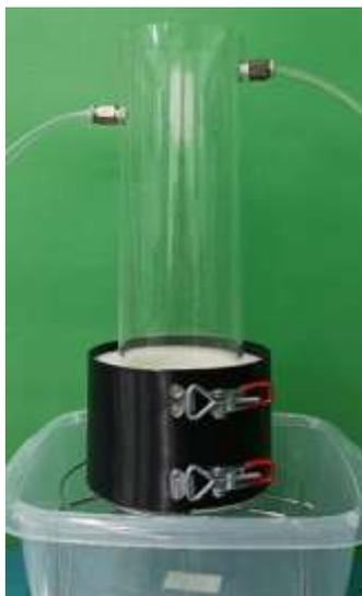
**Рисунок 3** – Лабораторный пермеаметр
