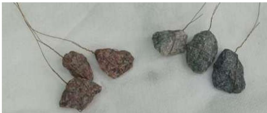
**Рисунок 2** – Каменный материал, подготовленный для определения адгезии ДПМ
