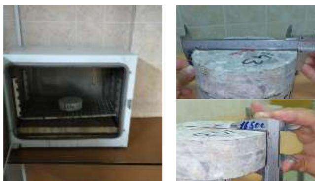
**Рисунок 3** – Тепловые испытания образцов бетона
