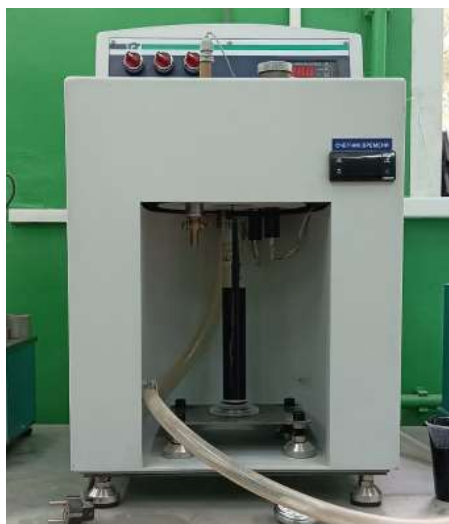
Рисунок 1 – Определение условной вязкости при помощи вискозиметра Редвуда ВУБ-БМ
