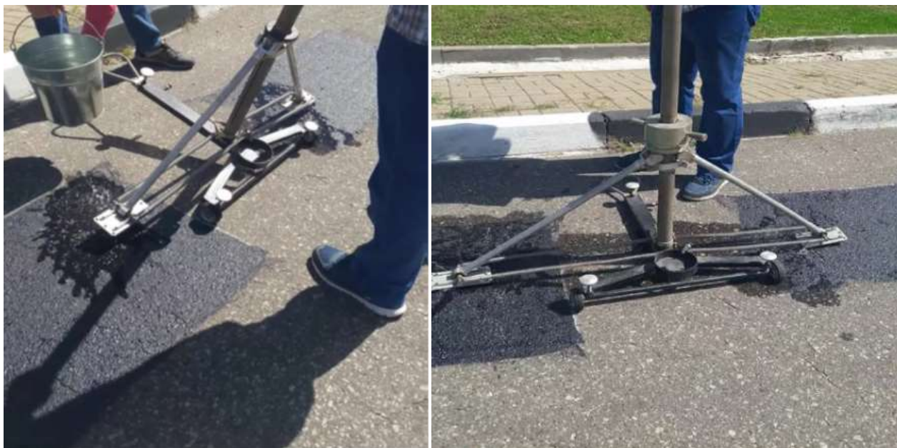
Рисунок 6 – Увлажнение дорожного покрытия и проведение замера коэффициента сцепления
