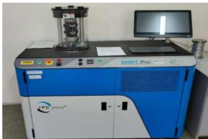
**Рисунок 3 – Испытательное оборудование АМРТ**
