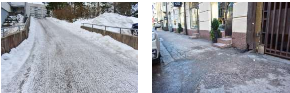
Рисунок 1 – Применение гранитной крошки против скользкости на городских дорогах Финляндии
