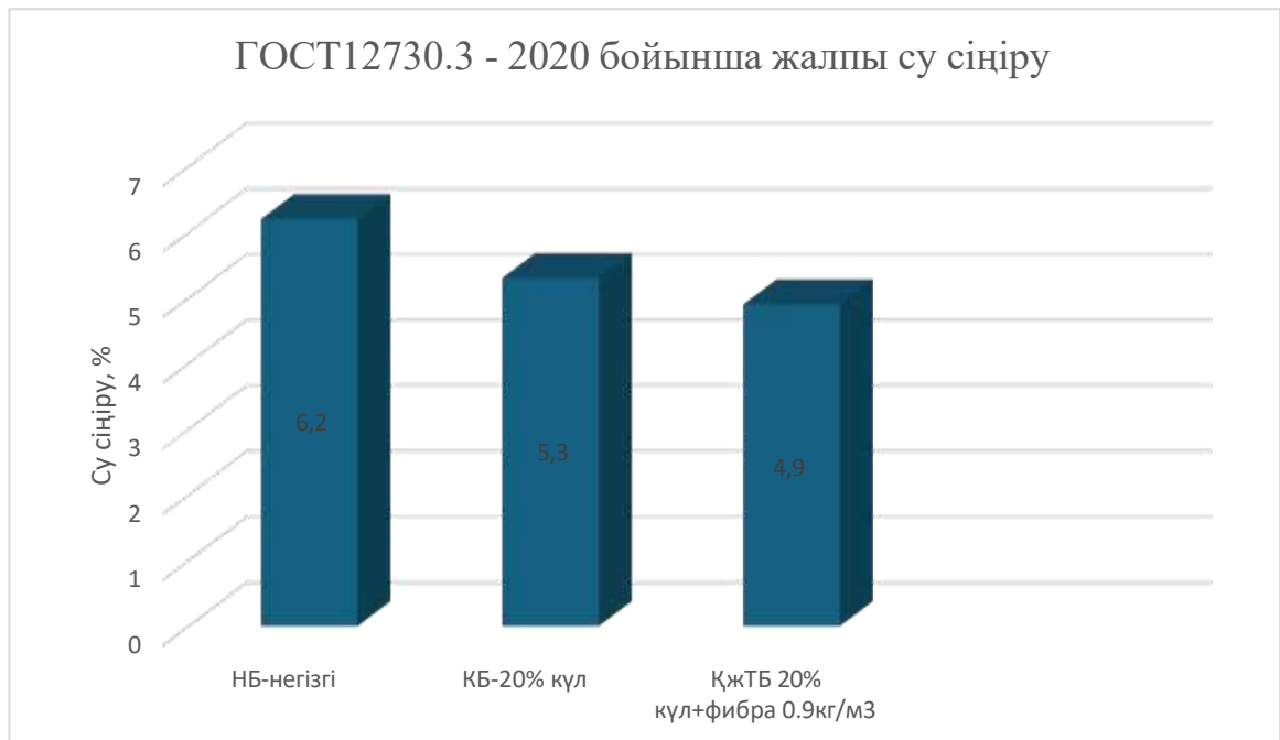
6 сурет - ГОСТ 12730.3-2020 бойынша әр үлгінің жалпы суды сіңіру қасиеттері
