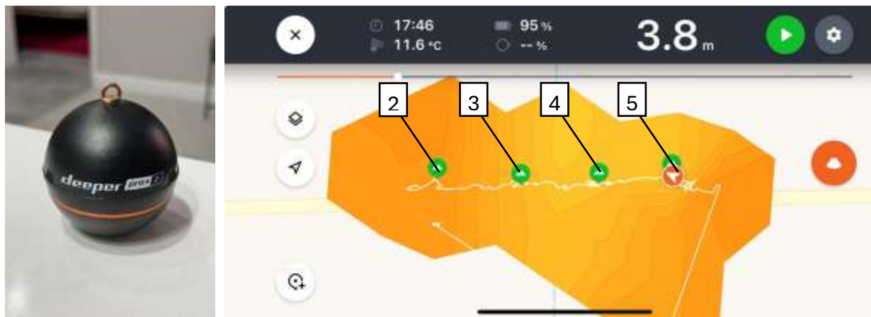
Рисунок 5 – Эхолот Deeper pro+ 2 и скриншот из программы Fish Deeper App в момент измерения глубины возле опоры № 5
