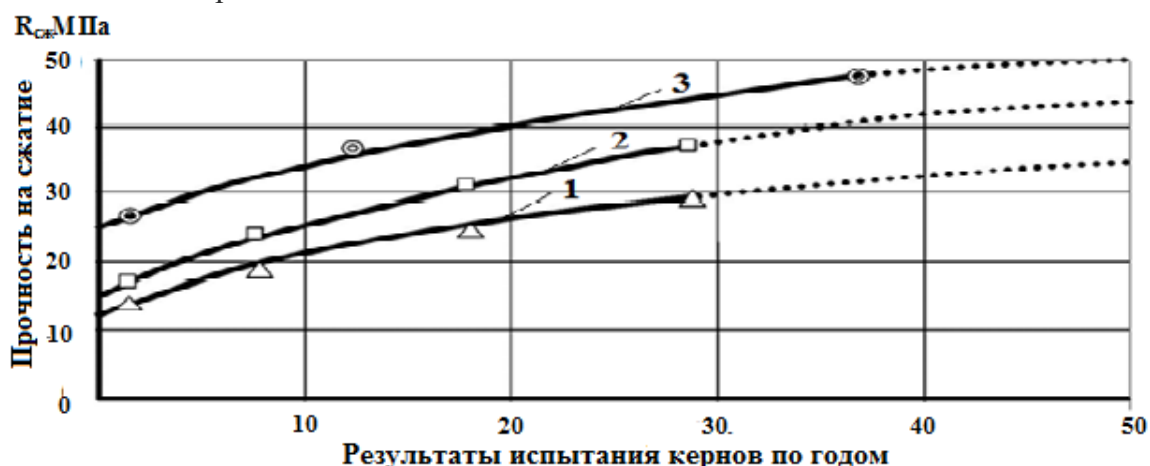
Рисунок 2 – Кинетика нарастания прочности дорожных покрытий из самовосстанавливающегося дорожного бетона на основе ТМО. Где: 1-зола ТЭЦ, 2-бокситовый шлам, 3- гранулированный шлак (доменный или фосфорный)
