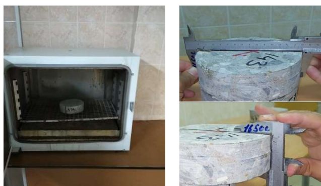
Рисунок 3 – Тепловые испытания образцов бетона
