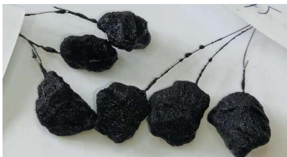
**Рисунок 5** – Пленка пропиточного состава №2 на сером и красном граните после кипячения
