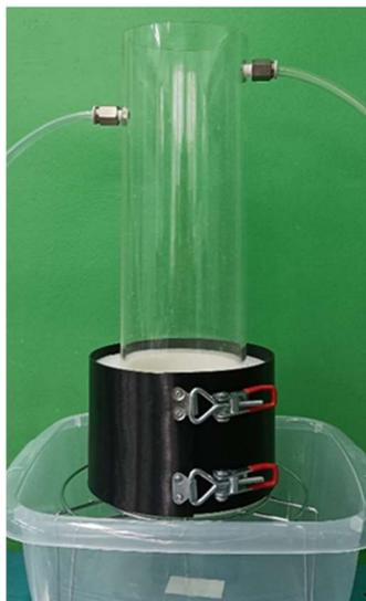
**Рисунок 3** – Лабораторный пермеаметр
